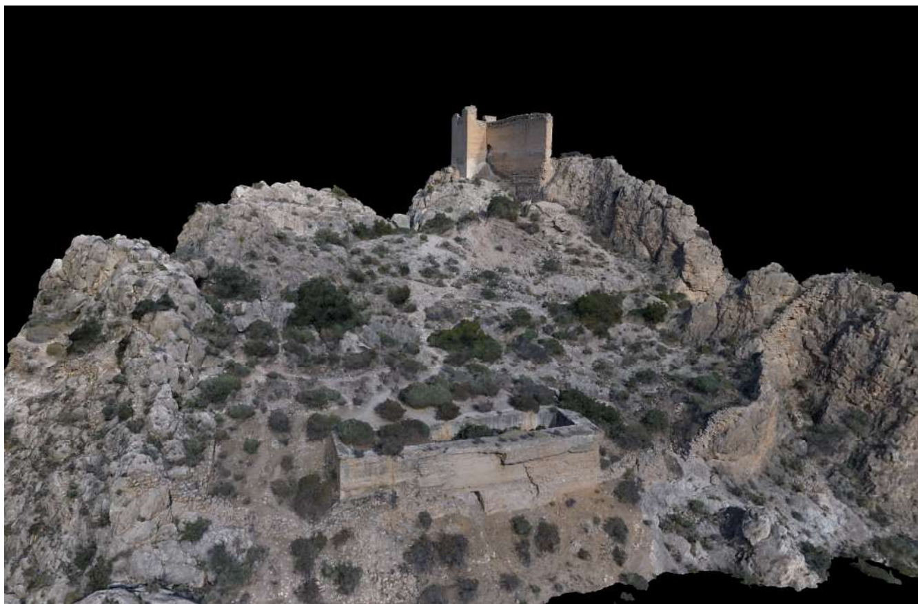
Figura 2. Modelo 3D de la alcazaba de Siyâsa (Cieza, Murcia) obtenido a partir del uso de fotogrametría aérea.
